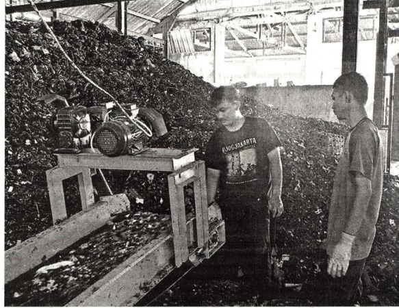
Petugas mengolah sampah organik hasil pemilahan menggunakan mesin pemilah di TPS3R Nitikan, belum lama ini. Nantinya, tumpukan sampah organik akan diolah menjadi kompos dan sebagian lainnya menjadi campuran bahan refuse derived fuel (RDF).
