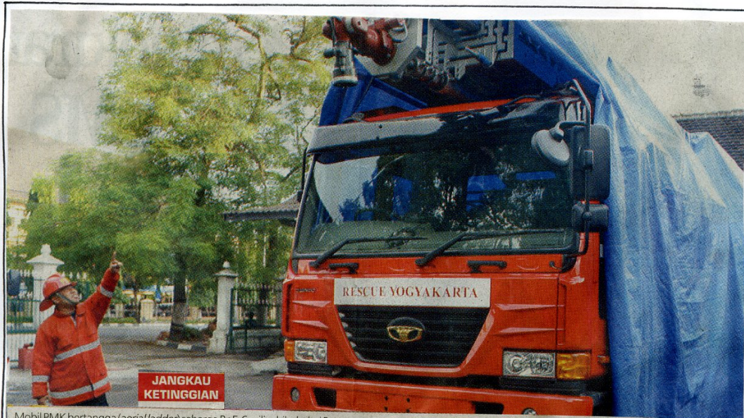
Mobil PMK bertangga (aerial ladder) seharga Rp5,6 miliar hibah dari Pemprov DIY kepada Pemkot Yogyakarta segera diuji coba. Petugas PMK kemarin menunjukkan tangga yang mampu menjangkau ketinggian 32 meter. Kendaraan ini dioperasikan untuk menanggulangi kebakaran di seputar Kota Yogyakarta.
